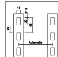
Schlitzabstand Standrohr | 45 mm
