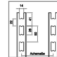
Schlitzabstand Standrohr | 50 mm
